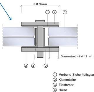
Abbildung 4: Querschnitt Tellerhalter
